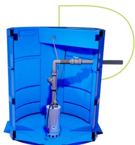
Canne de refoulement en PVC avec clapet à boule et vanne de 40 mm, avec sortie de refoulement de 1"1/4. Montage avec flexible souple à l'intérieur pour éviter les contraintes éventuelles sur la pompe.
