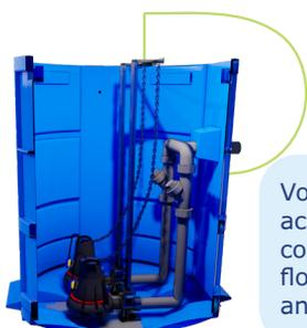
Canne de refoulement en PVC avec deux clapets à boule et vanne de 63 mm, montée sur un pied d'assise sur platine inox, facilitant l'accès à l'équipement en cas d'interventions de remise en état, avec barre de guidage en inox. **Possibilité de montage avec les pompes DGE 75 ou DW VOX.**
