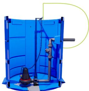
Canne de refoulement en PVC avec clapet à boule et vanne de 63 mm, équipée d'une sortie de refoulement. Montage sur pied d'assise en composite ou en fonte, et barres de guidage en inox.
