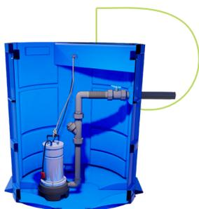
Canne de refoulement en PVC avec clapet à boule et vanne de 40 mm, équipée d'une sortie de refoulement de 1"1/4. Montage avec flexible souple à l'intérieur pour éviter les contraintes éventuelles sur la pompe.
